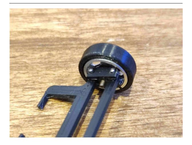
Die Bohrungen in der Vorderachse und dem Vorderachsträger müssen mit dem 1,1mm Bohrer aufgebohrt werden, sodass die genug Freigang haben.
